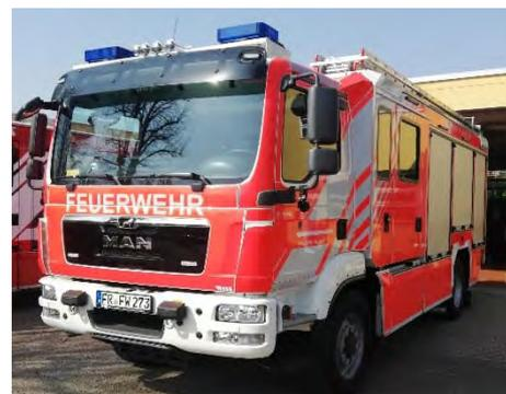
Anfang 2022 wurde das Hilfeleistungslöschfahrzeug (HLF 10) in Dienst gestellt. Neben der Normbeladung eines HLF 10 wurde eine ortspezifische Zusatzbeladung in Form eines Wassersaugers, Ölbindemittel und Sicherungsmaterial „Ölspur“ verlastet. Dieses Fahrzeug wird bei der Abteilung Tiengen der Freiwilligen Feuerwehr eingesetzt und ersetzt ein Fahrzeug aus dem Jahr 1995.
