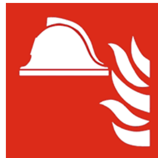
F004 Mittel und Geräte zur Brandbekämpfung
