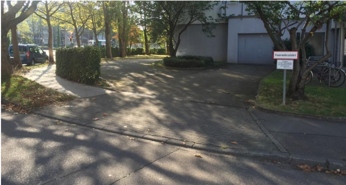
**Abbildung 9 - Bordsteinabsenkung im Bereich einer Feuerwehrezufahrt**
