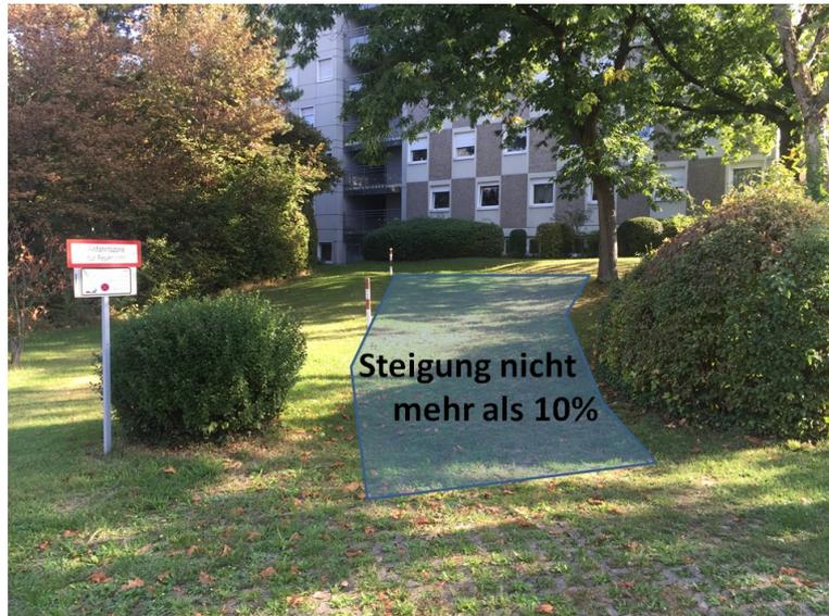
Abbildung 5 - Steigungen in Feuerwehzufahrten, Das Hinweisschild ist zu niedrig angebracht
