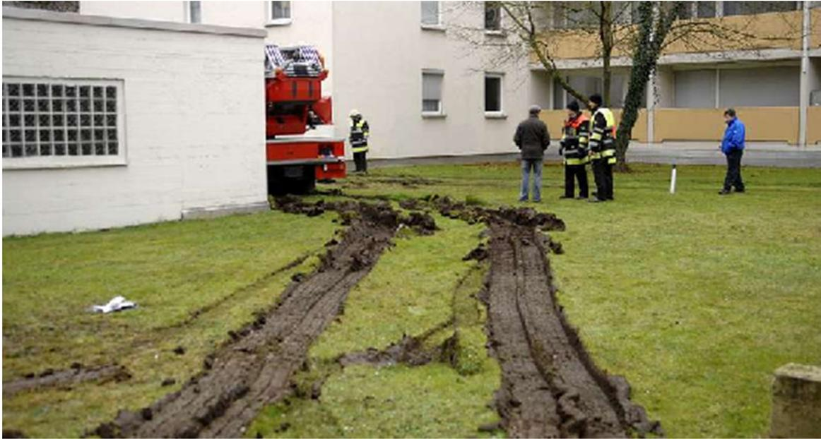
Abbildung 18 - Einsinken in nachträglich gebildeter Humusschicht oberhalb Schotterrasenschicht
