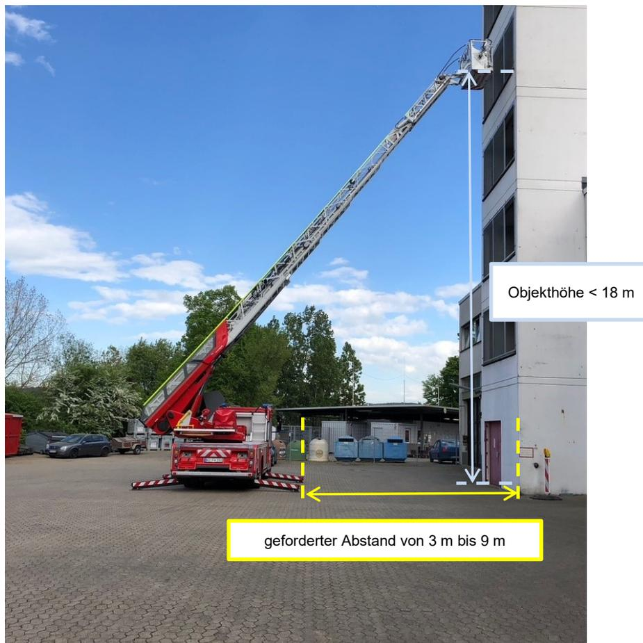
Abbildung 14 - Darstellung Anleiten eines Hubrettungsfahrzeuges
