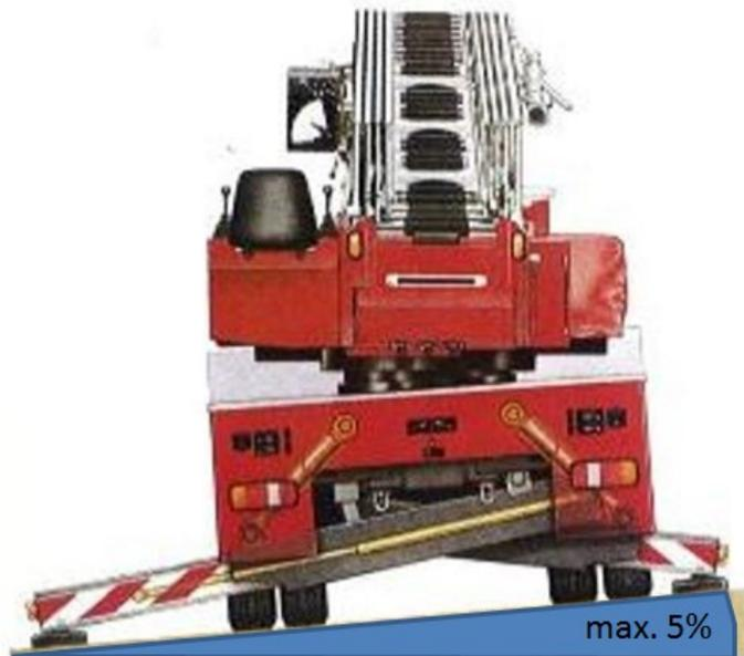
Abbildung 13 - Querneigung von Aufstellflächen verdeutlicht an einem Drehleiterfahrzeug
