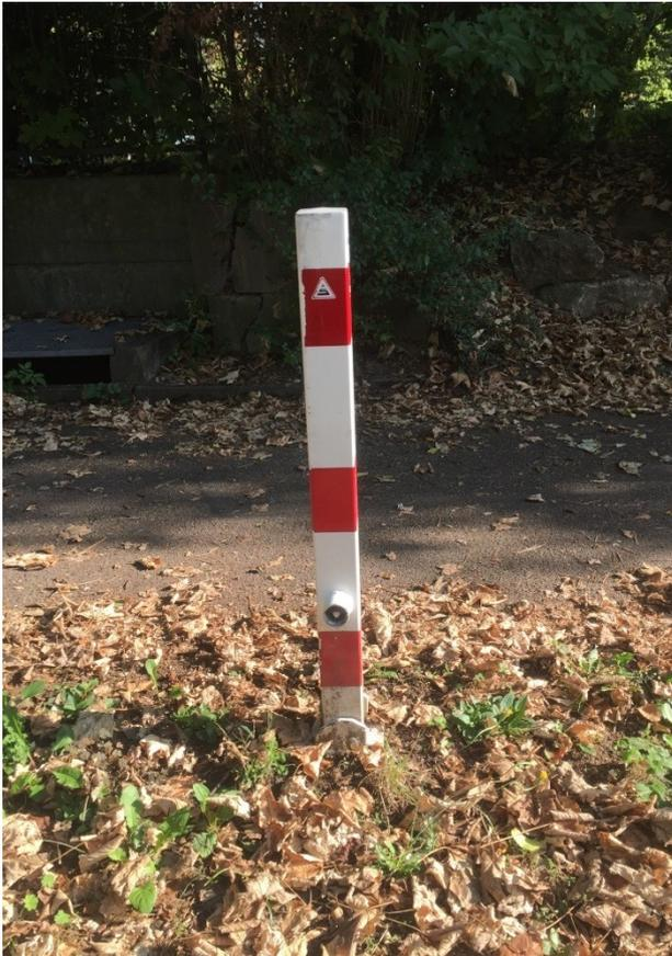
Abbildung 7 – Sperrpfosten mit Dreikantschloss nach DIN 3223
