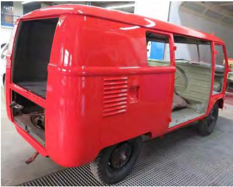
In Kleingruppen wurde ein TSF auf VW T1 (Bulli) Basis, Baujahr 1954, saniert. Das Fahrzeug soll in wenigen Monaten wieder fahrbereit und mit völlig neuem Äußeren versehen sein. Hierfür wurden im vergangenen Jahr bereits über 385 Stunden aufgewendet.
