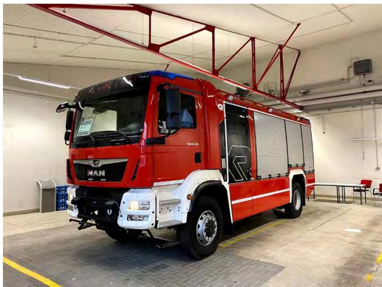
Das Fahrzeug ist auf einem 4x4 MAN Fahrgestell mit einem Aufbau der Fa. Rosenbauer konzipiert worden und ist ab März 2021 im Dienst. Neben der standortspezifisch ergänzten Normbeladung eines HLF 20 führt das Fahrzeug 5.000 l Wasser und 500 l Schaummittel mit sich.
